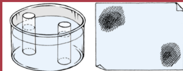
Figure 4- Lauterbur valide ses idées grâce à une expérience épurée à l'extrême, d'une redoutable efficacité : il parvient à visualiser par résonance magnétique la position de deux éprouvettes d'eau normale placées dans un bac d'eau « lourde ».
